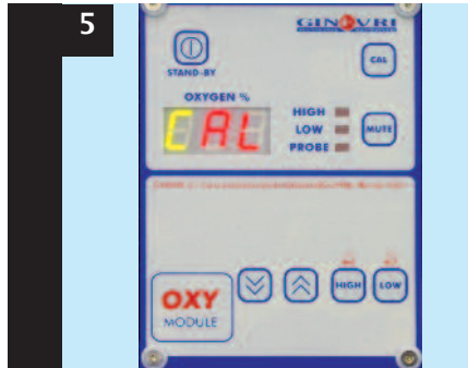
Mô-đun O2. (PN 10396A70). Theo dõi nồng độ O2 bên trong máy hút mùi và trong mạch của bệnh nhân thở máy.
